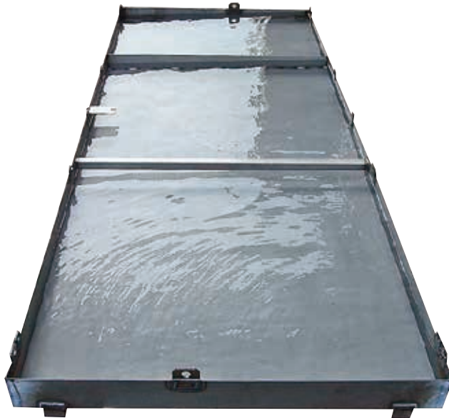
▲ 水張り検査工程
