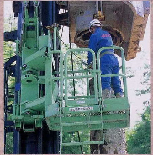
▲LG200T昇降式作業床
